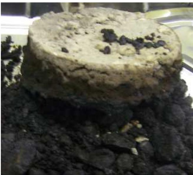
Asfalto dopo combustione
